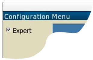
A janela de configuração principal (Ajuste do sistema) pode rodar em nível Básico ou Avançado através de um campo no canto superior esquerdo da janela. Quando está no modo Básico, alguns ajustes menos usados (ou mais avançados) são ocultados. Nas descrições abaixo, todos os parâmetros marcados com asterisco estão visíveis somente no modo avançado.
