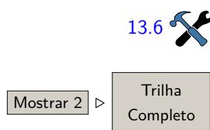
A visualização do rastro pode ser ajustada entre Desligado, Curto (+/- 10 minutos), Longo (+/- uma hora) ou Completo que mostrará todo o vôo. Isto pode ser ajustado através dos ajustes de configuração ou temporariamente através do menu.
