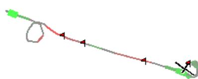
Se houver conexão do Vega ou outro variômetro inteligente com a saída Netto, o valor do vário Netto é usado; consequentemente as cores e a espessura do rastro indicarão o movimento vertical da massa de ar ao invés do movimento vertical da aeronave.
