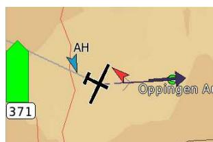
O registro da aeronave FLARM ou o nome do piloto pode ser visível no mapa através da localização da identificação ICAO da aeronave de tráfego FLARM no arquivo. Veja seção [14.11](#) para mais detalhes do formato do arquivo. As aeronaves com privacidade FLARM não terão qualquer identificação mostrada.
