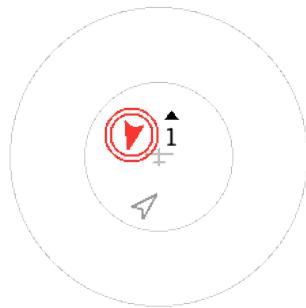
o tráfego de ameaça é enfatizado com um ou dois círculos em volta do ícone de seta. A visualização usada para este pequeno radar pode ser configurada..
