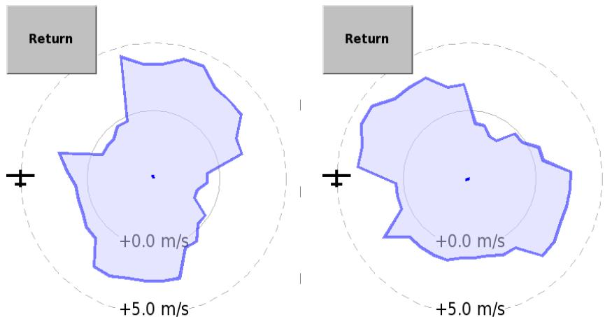
As duas imagens acima foram tiradas uma após a outra para demonstrar o uso prático do gráfico de subida rotativa. A receita simples para otimizar a taxa de subida usando o assistente de termal é descrita repetindo-se os passos a seguir:
