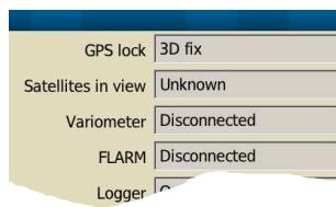
Usada primariamente como um verificador do sistema, para ver como o computador e os dispositivos conectados estão funcionando. É acessado através do menu e selecionada a aba **Sistema**.
