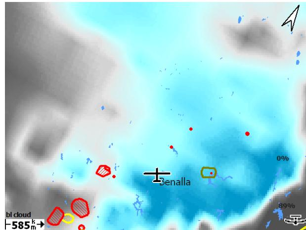
**Sfc temp** : a temperatura na altura de 2m acima do nível do solo. Pode ser comparada para observar a temperatura da superfície como um indicador do modelo de previsão da precisão – se observadas temperaturas da superfície abaixo da prevista, as condições de vôo planado serão piores do que a previsão.
