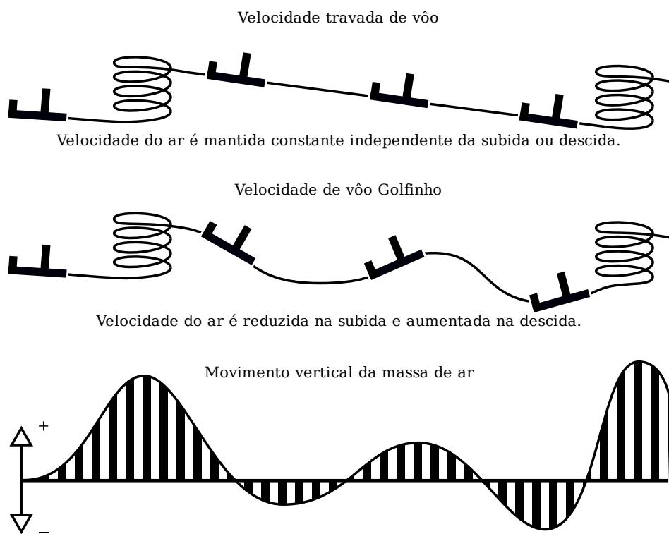
A opção de configuração “travar velocidade” (veja seção 13.11) pode ser usada para especificar tanto as velocidades de golfinho como a velocidade travada. A infobox ‘V Opt’ mostra a velocidade ideal de acordo com o modo selecionado. Quando conectado com o variômetro inteligente Vega, o som do comando de velocidade é baseado no valor ideal de velocidade.
