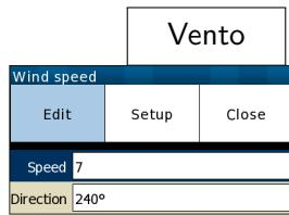
O vetor de vento estimado pelo XCSoar. O ajuste manual é possível e está conectado com a janela e a infobox. Apertando o cursor acima/abaixo através dos ajustes e para ajustar os valores, tecle direita/esquerda.
