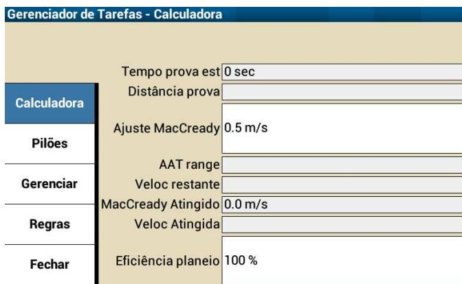
**Tempo Prova est :** este campo mostra o tempo total para completar a prova usando o ajuste de MacCready introduzido.
