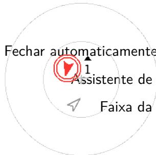
Fechar automaticamente FLARM\* : fechará o radar FLARM quando não houver tráfego FLARM.
