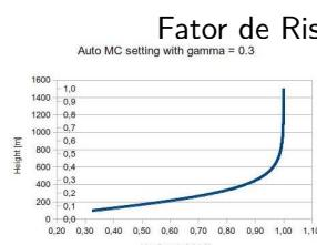
o fator de risco STF reduz o ajuste de MacCready usado para calcular a velocidade ideal quando o planador está baixo para compensar o risco. Ajuste 0,0 para não compensado, 1,0 faz o MacCready linear com o peso (com referência à altura de subida máxima). Se optar por esta configuração, o valor de 0,3 pode ser recomendado. Veja Seção [6.7](#) para mais detalhes.
