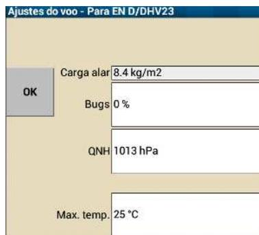
O 'Bugs' determina a quantidade de degradação da polar devido à contaminação durante o vôo. O valor de 0% irá fazer o software deixar a polar limpa. Um ajuste de 50% fará a degradação da polar e dobrar a taxa de afundamento para a mesma velocidade.
