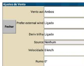
A qualquer instante durante o vôo, o piloto pode fazer correções na estimativa do vento, entrando com a correção na janela de ajuste de vento. Uma vez a janela fechada, a estimativa interna é ignorada até que haja nova estimativa obtida através do algoritmo de zigzag ou em modo girando.
