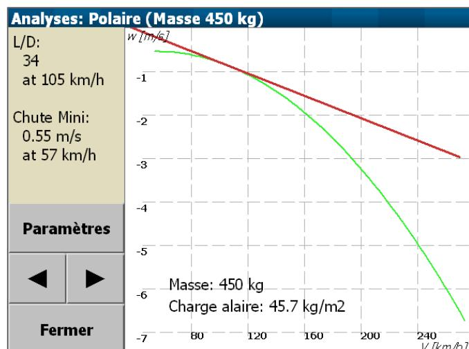
Dans cette page de dialogue, le bouton “Paramètres” ouvre la page “Configuration vol” et permet de régler en vol les paramètres ‘Ballast’, ‘Moucherons’, ‘QNH’ et ‘Temp. max.’.
