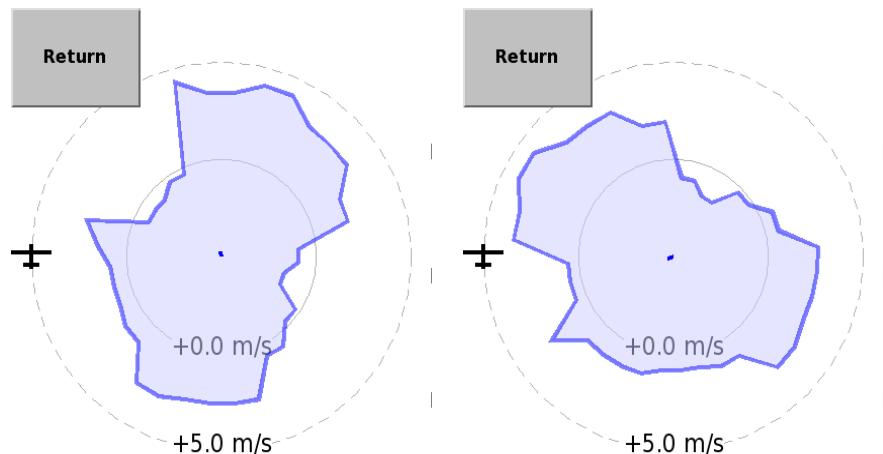
Les deux copies d'écran sont prises à quelques secondes d'intervalle pour montrer l'utilisation pratique du diagramme de taux de montée pivotant. Une façon simple d'optimiser le taux de montée en se basant sur l'assistant est de suivre de manière répétitive les deux étapes suivantes :
