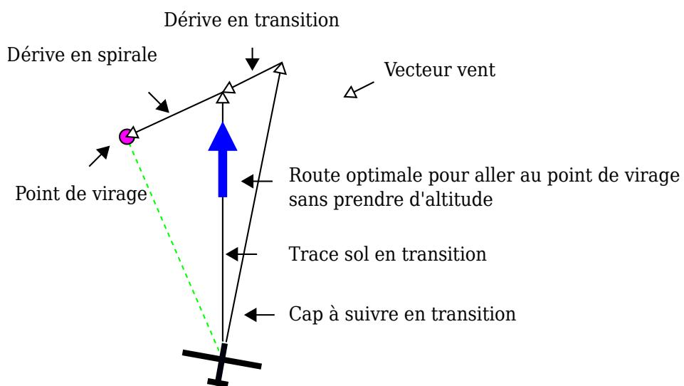
La direction de la route optimale est affichée sous la forme d'une flèche bleue épaisse. Elle indique la direction optimale que doit suivre la trace au sol du planeur en transition. Par exemple, si l'affichage est paramétré "Route en haut" il faut manœuvrer pour faire en sorte que la flèche bleue soit dirigée vers le haut, et donc parallèle à la route.
