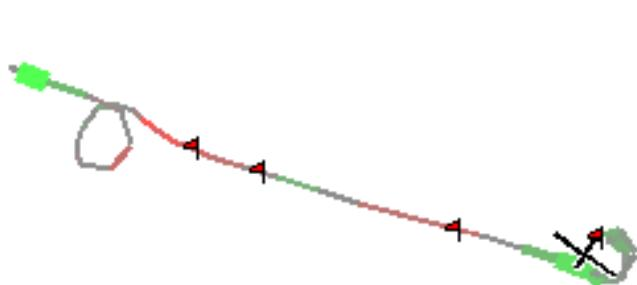
Si un Vega ou un autre variomètre intelligent est connecté avec une sortie "Netto", la valeur du vario Netto est utilisée. Alors la couleur et l'épaisseur de la trace sol représentent la vitesse verticale de la masse d'air à la place de celle du planeur.
