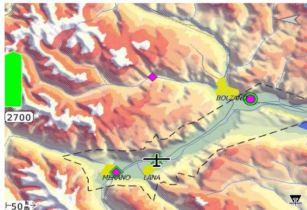
**Contourne :** Si le mode “contournement” est activé, alors la zone atteignable montre la plus grande distance que le planeur peut parcourir en arrivée dans toutes les directions, même en contournant des obstacles<sup>3</sup>. La limite ressemble alors à une boucle fermée autour du planeur, mais peut aussi inclure des trous indiquant des sommets de montagne que le planeur ne peut pas atteindre sans reprendre d’altitude.
