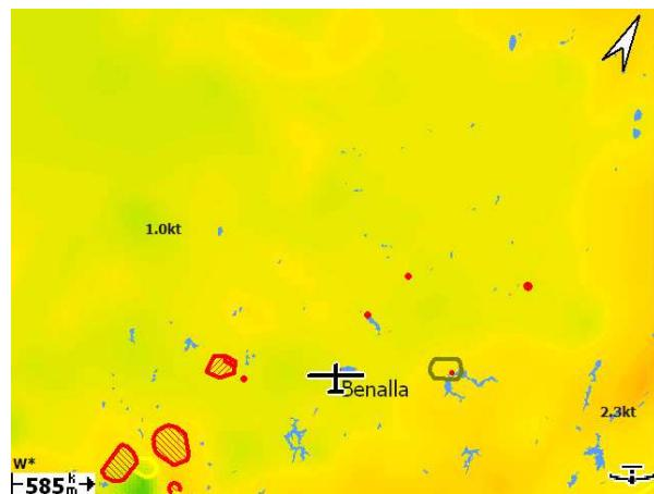
**BL wind spd** : La vitesse et la direction du vecteur moyen du vent dans la couche-limite. Cette prédition peut être trompeuse s'il y a un fort changement de direction du vent dans la couche limite.
