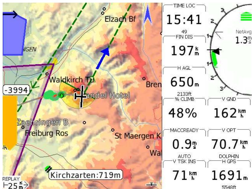
FIGURE 3.1 – Disposition typique de l'écran principal d'XCSoar
