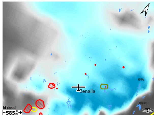
**Sfc temp** : La température à 2 m au-dessus du sol. Elle peut être comparée aux températures de surface observées afin d'avoir une indication sur la qualité des prévisions du modèle ; par ex. si les températures observées au sol sont significativement plus faibles que celles de la prévision, les conditions de vol à voile seront moins intéressantes que prévues.
