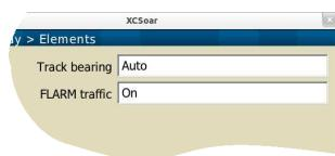
**Trace sol** : Affiche la trace au sol (projection sur le sol). "Auto" permet d'afficher la trace sol si elle est significativement différente du cap à suivre.
