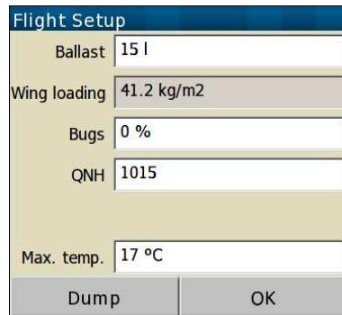
Le paramètre “Moucherons” défini la dégradation de la performance aérodynamique de l'aile causée par la contamination au cours d'un long vol. Avec un “moucherons” mis à 0 %, XCSoar utilisera une polaire propre. Avec un “moucherons” mis à 50 %, la polaire sera dégradée et doublera le taux de chute à une vitesse donnée.
