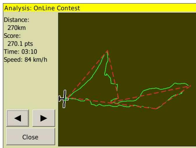
En vol OLC, les circuits AAT ou non AAT peuvent encore être utilisés pour la navigation. En vol, le calculateur optimise le vol en accord avec les règles OLC choisies.
