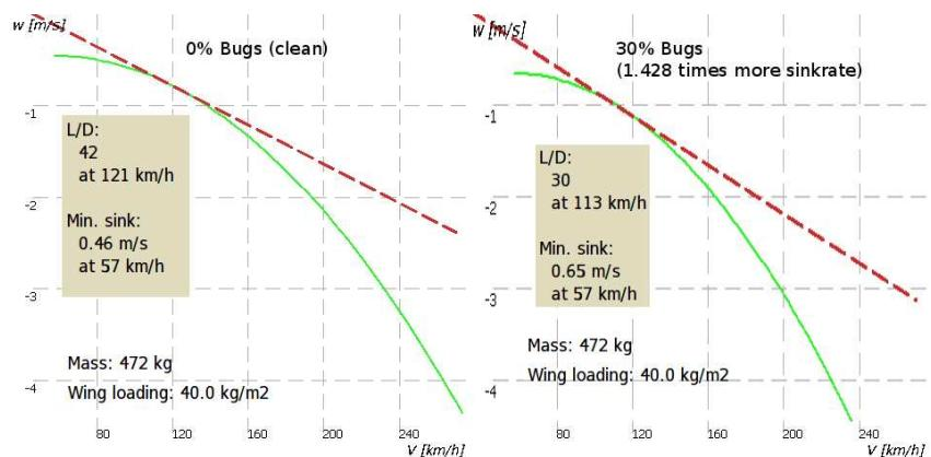
Sachant cela, un réglage pertinent pour une aile extrêmement contaminée par des moucherons pourrait aller jusqu'à 30 %. Seuls des tests permettront de connaître les valeurs correctes pour les moucherons, car la dégradation des performances diffèrent d'un planeur à l'autre.
