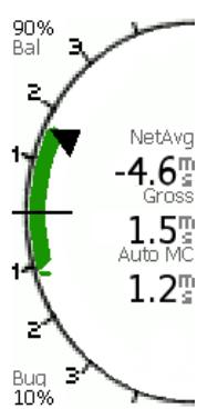
De plus, les flèches de vitesse optimale (chevrons) sont au-dessus ou en dessous les valeurs du variomètre. Des chevrons pointant vers le haut recommandent de ralentir. Des chevrons pointant vers le bas recommandent d'accélérer.
