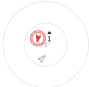
Radar FLARM : Permet l'affichage des informations radar FLARM.
