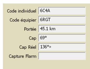
En vol, le pilote peut donner son code équipe, personnel, à son équipier, à l'aide de la fenêtre "code équipe", afin que celui-ci dispose de votre position de façon cryptée. Quand il entend le code d'un équipier, il appuie sur **Définir code** pour ouvrir le fenêtre de saisie de texte permettant d'entrer le code de son équipier.
