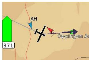
Les trafics FLARM sont représentées sur la carte par des flèches rouges dont la pointe montre la direction de l'aéronef ayant un FLARM ainsi que le risque de collision. Notez que l'orientation des flèches dépend du mode d'affichage de la carte. Par exemple, si le mode d'affichage est "Route en haut", les flèches pointent vers la direction relative des trafics par rapport au planeur. Si le mode d'affichage est "Nord en haut", les flèches pointent vers la direction des routes absolues des trafics.
