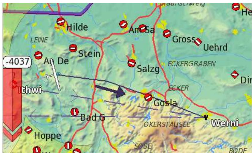
Le calcul d'optimisation de la route est basé sur la polaire du planeur. Les routes sont optimisées pour minimiser le temps de vol. Par défaut, le calcul d'optimisation de route est inactif. Il peut être activé pour prendre en compte uniquement le relief ou le relief et les espaces aériens.
