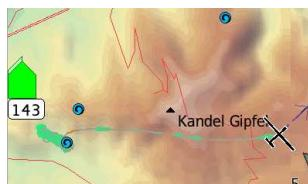
En montée dans les thermiques, des marques sont créées automatiquement et affichées à l'écran. La position des 20 derniers thermiques est stockée jusqu'à la fin du vol. Cette historique des thermiques est accessible par la fonction "Qu'y-a-t'il ici?", de la même façon que les autres marques et les points de virage.
