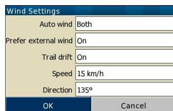
À n'importe quel moment au cours du vol, le pilote peut apporter des corrections à l'estimation du vent en entrant des corrections dans la fenêtre de paramétrage du vent. Une fois la fenêtre fermée, l'estimation interne est ignorée jusqu'à ce qu'une nouvelle estimation interne soit obtenu par les algorithmes de spirale ou zigzag.
