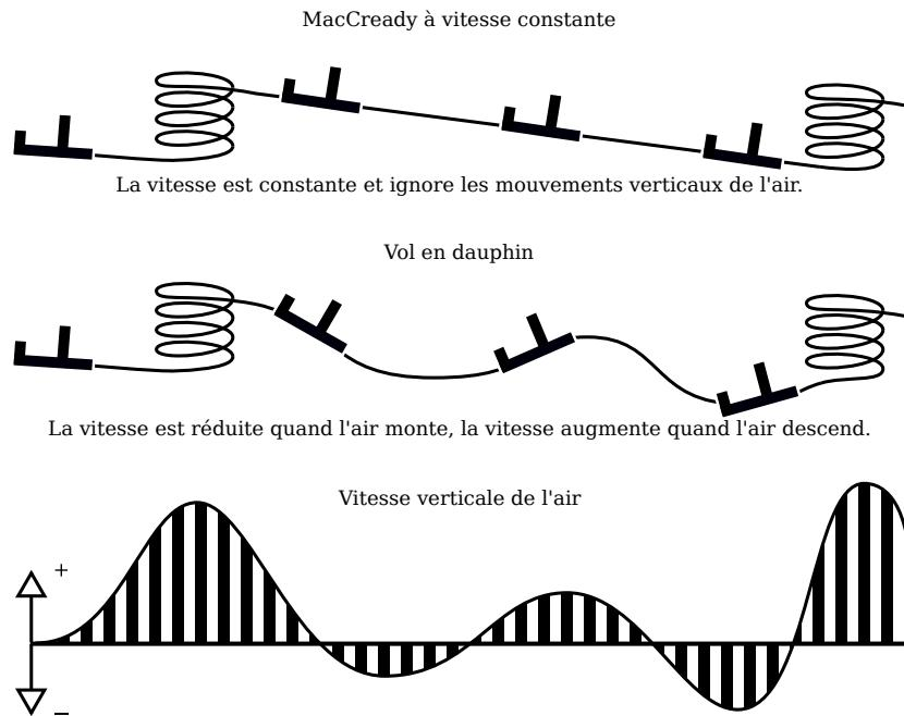
Un paramètre de configuration ‘Vitesse de croisière bloquée’ (voir section 12.10) peut être utilisé pour définir si c'est la vitesse de vol en dauphin ou la vitesse constante qui est utilisée. L'InfoBoxe ‘V Opt’ montre la vitesse optimale selon le type de calcul qui est sélectionné. Connecté à un variomètre intelligent Vega, les sons de la “vitesse à suivre” reflètent cette vitesse optimale.
