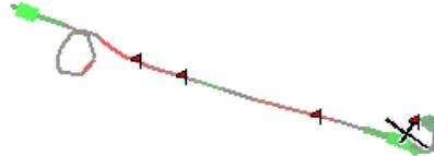
Se houver conexão do Vega ou outro variômetro inteligente com a saída Netto, o valor do vário Netto é usado; conseqüentemente as cores e a espessura do rastro indicarão o movimento vertical da massa de ar ao invés do movimento vertical da aeronave.
