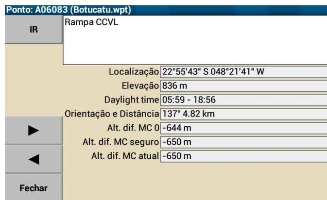
Como citado acima, a janela de diálogo do waypoint também mostra três formas de diferença de altitude (altitude adicional necessária para alcançar o waypoint a uma altura segura) para o waypoint correspondente:
