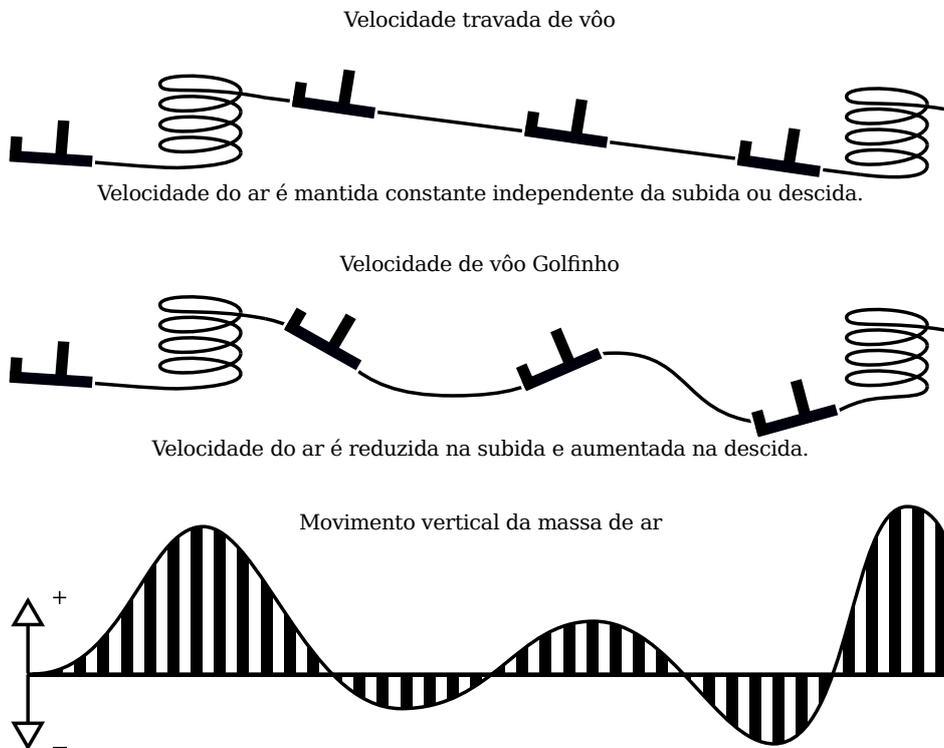
A opção de configuração “travar velocidade” (veja seção 13.11) pode ser usada para especificar tanto as velocidades de golfinho como a velocidade travada. A infobox ‘V Opt’ mostra a velocidade ideal de acordo com o modo selecionado. Quando conectado com o variômetro inteligente Vega, o som do comando de velocidade é baseado no valor ideal de velocidade.
