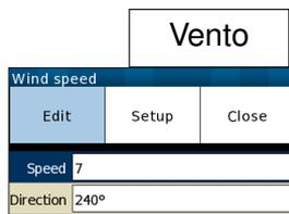
O vetor de vento estimado pelo XCSoar. O ajuste manual é possível e está conectado com a janela e a infobox. Apertando o cursor acima/abaixo irá através dos ajustes e para ajustar os valores, tecle direita/esquerda.
