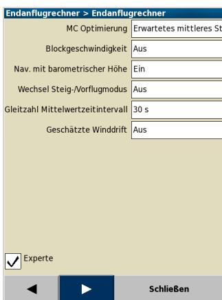
**MC Optimierung**: Diese Option setzt fest, welcher MC-Algorythmus verwendet wird. Mehr dazu in Kap. [6.13](#).
