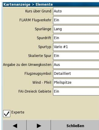
**FLARM Flugverkehr :** **Ein:** Anzeige des FFalarm Flugverkehrs auf der Moving Map.
