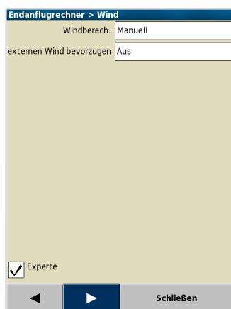
*Windberech* : Auswahl des entsprechenden modus für Ermittlung des Windes in XCSoar
