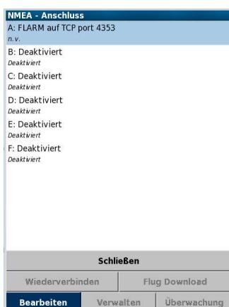
Standard ist COM1 und 4800 baud. Es können insgesamt 6 Geräte angeschlossen werden (Gerät A .. F). So kann eines z.B. als GPS-Quelle benutzt werden und ein anderes als externes variometer. Wenn kein weiteres Gerät angeschlossen werden soll, so ist im Auswahlfeld des entsprechenden Anschlusses "Deaktiviert" auszuwählen. XCSoar wird diese Anschlüsse dann ignorieren und keine Zeit mit der Suche nach einem Gerät an dem Anschluß verbringen.
