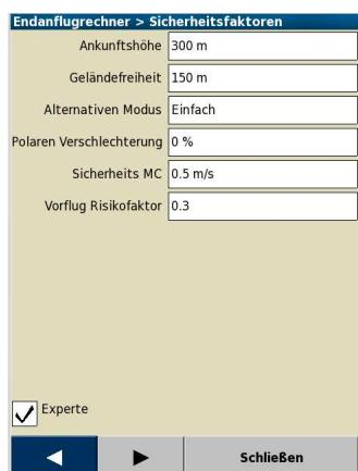
**Ankunfts Höhe**: Sicherheitshöhe. Diese gibt die Höhe über Grund am Zielpunkt an, in der das Flugzeug für eine sichere Landung ankommen sollte. Gesetzt auf Null bedeutet, daß man am Zielplatz in Null Meter Höhe "aufschlägt".
