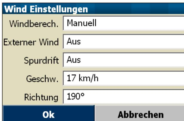
Wenn der Dialog geschlossen wird, werden die ermittelten Werte solange benutzt, bis neue Werte aus der ZickZack- oder Kurbelmessung vorliegen.
