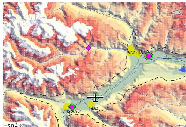
Der Weg des Endanfluges wird permanent auf evtl. Kollisionen mit einer Geländeerhebung geprüft – sollte sich eine Kollisionsgefahr ergeben, so wird der vorausgesagte Kollisionspunkt mit dem Gelände als kleines rotes Kreuz auf der Karte dargestellt.
