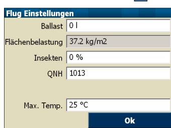
Mithilfe der Mückeneinstellung ('clean') kann während des Fluges nachjustiert werden, wie sich die Polare durch Mückenbefall verschlechtert. Ein Setzen auf 100% 'clean' bedeutet, daß die Software annimmt, das Flugzeug bzw. das Profil ist top sauber.
