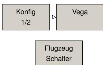
Wenn das VEGA Variometer angeschlossen ist, erscheint gibt es ein zusätzliches Menü für die am VEGA angeschlossenen Schalter und Eingänge. Ohne VEGA ist dieser Menü-Button grau, also nicht verfügbar.
