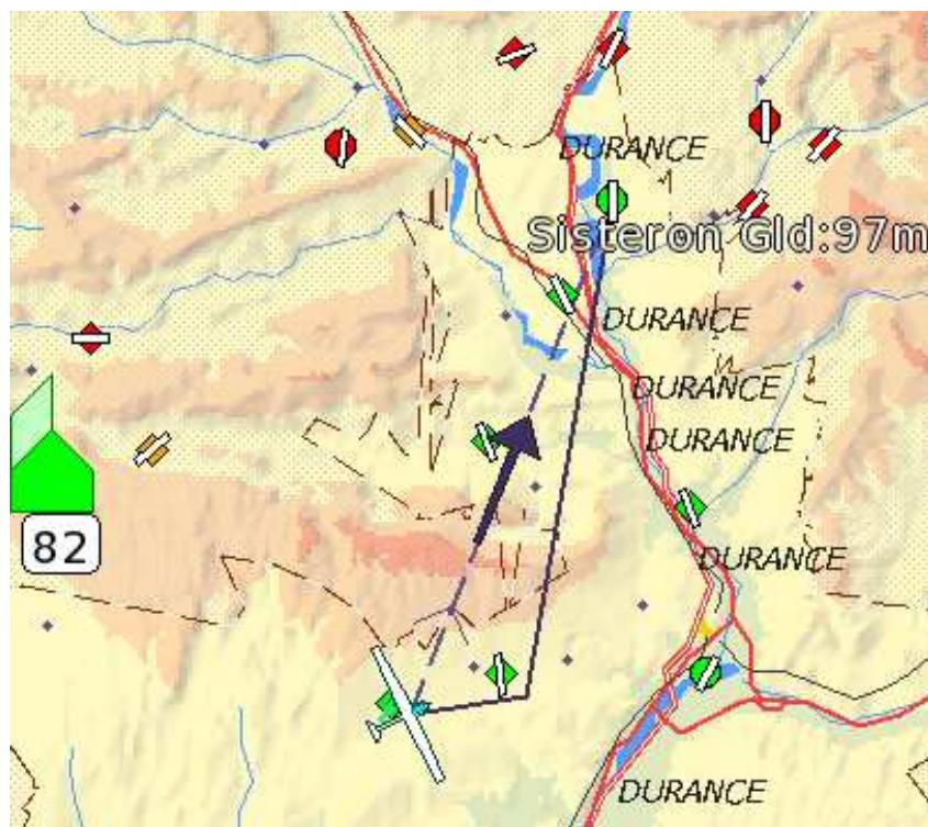
Bei der Routenberechnung wird die Strecke unter Berücksichtigung der Flugzeugpolaren zeitoptimiert berechnet. Standardmäßig ist die Routenfunktion ausgeschaltet. Sie kann aktiviert werden unter Berücksichtigung von Lufträumen, Gelände, Wolkenuntergrenze.
