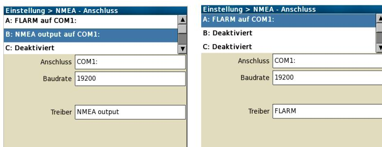
Auf diese Art und weise werden beide Geräte mit den identischen Daten versorgt, so, als ob sie direkt vom Flarm , VEGA, o.ä. kämen. Auf gleiche Weise können zwei Altair mit identischen Daten versorgt werden, wenn nur eine Datenquelle zur Verfügung steht.
